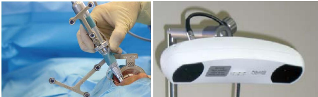
Figure 15 : Marqueur et télémètre du système Robodent®.
