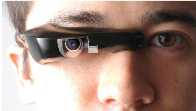
Figure 20 : Homme portant un modèle uni-oculaire de l'EyeTap.
