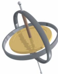
Figure 17 : Illustration d'un gyroscope à 3 axes effectuant un mouvement de précession.
